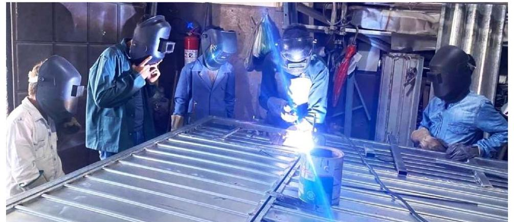
**Elektrisches Schweißen (Herstellung von Eisen-Toren, Gittern usw.)**
